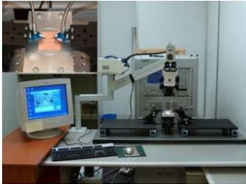
Fig. 8 - Sistema di misura operante fino a 110 GHz
