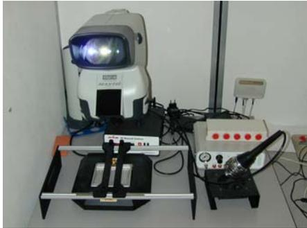
Fig. 4 - Stazione di saldatura a infrarossi.
