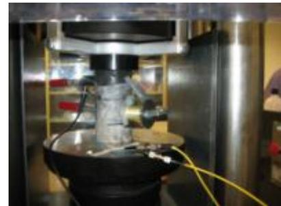
Fig. PD1: Misure di onde acustiche su campioni di roccia compressi all'interno di una macchina uniaassiale
